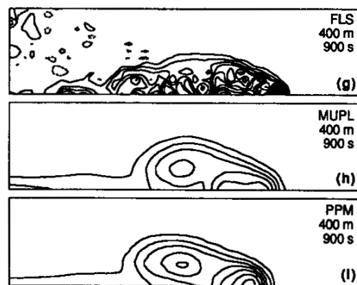
Abbildung 3.26: Abbildung 5g-1 aus Straka et al. (1993). Gezeigt ist die Dichteströmung zum Zeitpunkt t = 900\text{s} in 3 verschiedenen Simulationen mit verschiedenen numerischen Modellen und verschiedenen numerischen Methoden bei einer Auflösung von 400 m. Für die verwendeten numerischen Modelle und numerischen Methoden sei auf Straka et al. (1993) verwiesen. Die Konturlinien zeigen die Abweichung der potentiellen Temperatur vom Hintergrund \theta' und gehen wie in Abb. 3.20 von -16.5\text{K} bis -0.5\text{K} mit einem Intervall von 1 K.
