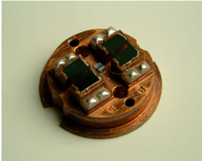
Abbildung 2.7: Teil des Probenhalters mit den Si-Chips auf den Kupferblöcken zur Messung der in-plane-Wärmeleitfähigkeit. Die Spaltbreite beträgt 1 mm.
