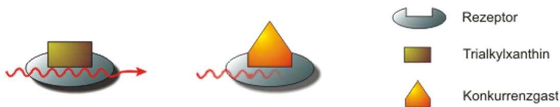
Abbildung 35: Konzept zum kompetitiven Nachweis von Koffein im sichtbaren Bereich. Der Komplex mit Koffeinderivaten ist transparent, dagegen absorbiert der Komplex mit dem Konkurrenzgast.
