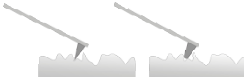
Abb. 4.45: Die sehr feine AFM-Spitze ist in der Lage auch sehr feine Oberflächenstrukturen zu erkennen, wo hingegen die stumpfe AFM-Spitze wegen ihres erhöhten Kontaktradius, nur gröbere Strukturen erkennen kann.
