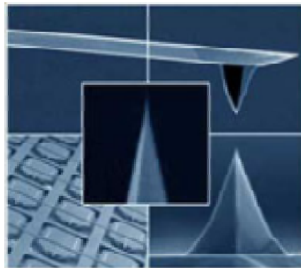
Abb. 4.43: AFM-Spitze aus einem Si-Einkristall: Die eigentliche AFM-Spitze (Bild unten rechts und Mitte) wird von einer mikroskopischen Blattfeder ( Cantilever ) getragen (Bild oben). Der Cantilever ist wiederum an einem sogenannten AFM-Chip angebracht, der der Anbringung am Messinstrument dient (Bild unten links). Bild: Nanoscience Instruments, Inc.
