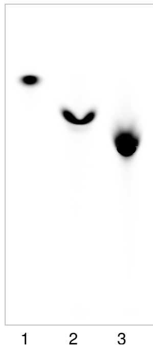
Abbildung 2.7: Unterschiedliches Laufverhalten von 14 C-Citrullin in der Dünnschichtchromatographie. Charakteristische Citrullinflecke in 50% Ethanol (1), im Zellüberstand (2) und im Zelllysate (3). Dies zeigt die Abhängigkeit der R f -Werte von der Zusammensetzung der mobilen Phase. Auftragung auf Kieselgel-beschichtete DC-Fertigplatten mit Laufmittel Chloroform : Methanol : Ammoniumhydroxid : Wasser (0,5 : 4,5 : 2,0 : 1,0).
