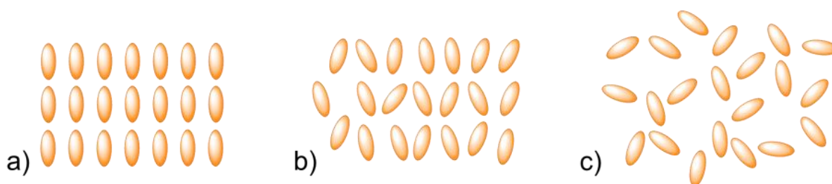
Abb. 5.4: a) kristalline Phase, b) flüssigkristalline Phase, c) flüssige (isotrope) Phase.
