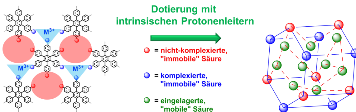
Abb. 2.4: Idealisiertes Strukturmodell eines dotierten, nicht-klassischen Aluminiumphosphonat-Netzwerkes mit p -6PA-HPB als Linker und einem dreiwertigen Metallkation als Konnektor.
