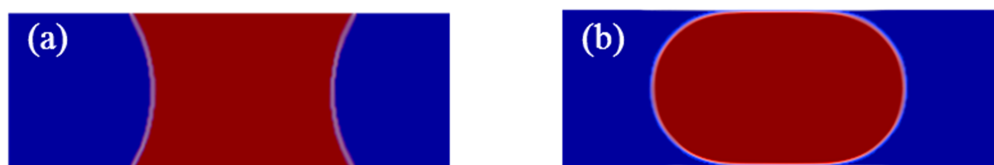
Abbildung 1: Möglichkeiten zur Segmentierung des Flusses. Dabei kann die disperse Phase entweder (a) die Kanalwand teilweise benetzen oder (b) Tropfen ausbilden.
