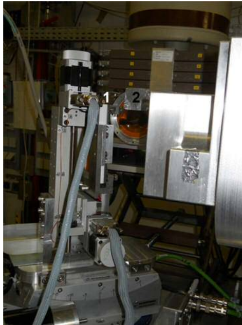
Abbildung IV-11: Experimenteller Aufbau an der MARS-Beamline am Synchrotron Soleil; 1: Probenhalter, 2: 13-Element Ge-Detektor
