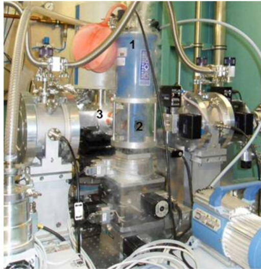
Abbildung VI-4: Experimenteller Aufbau an der INE-Beamline an ANKA; 1: Kryostat, 2: Fester zum Probenraum, 3: Festkörperdetektor
