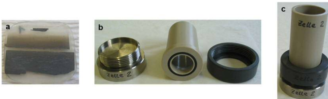
Abbildung IV-7: a) Opalinuston-Dünnschliff; b) Sorptionszelle - auseinandergebaut; c) Sorptionszelle - zusammgebaut
