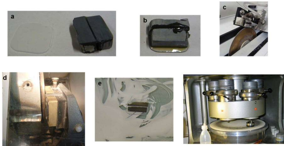
Abbildung IV-6: Arbeitsschritte zur Präparation der Dünnschliffe: a) links: Glasobjektträger, rechts: OPA; b) auf den Glasobjektträger geklebter OPA; c) Ablängen der Probe auf \sim 150 \mu\text{m} mit einer Gesteinssäge; d) grobes Schleifen der Probe auf \sim 80 \mu\text{m} mit einer Topfscheibe; e) Feinschleifen der Probe auf \sim 50 \mu\text{m} mittels SIC 1200; f) Polieren der Probe
