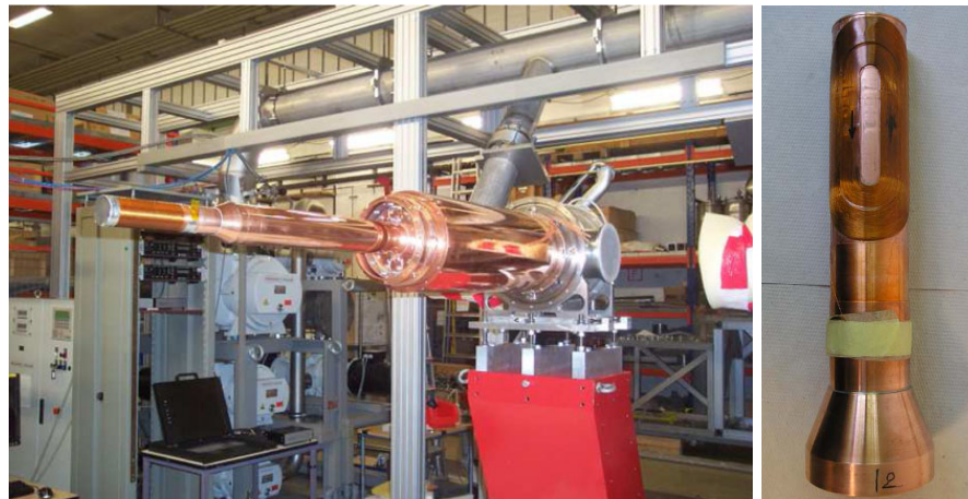
Abbildung 29: Kryostat des dynamisch polarisierten Festkörpertargets ohne äußere Hülle in Warteposition (linkes Bild): Man sieht an der Spitze die longitudinale Haltespule, im Hintergrund den Pumpenstand [Tho11]. Das rechte Bild zeigt die longitudinale Haltespule vor ihrer Montage [Orto9].
