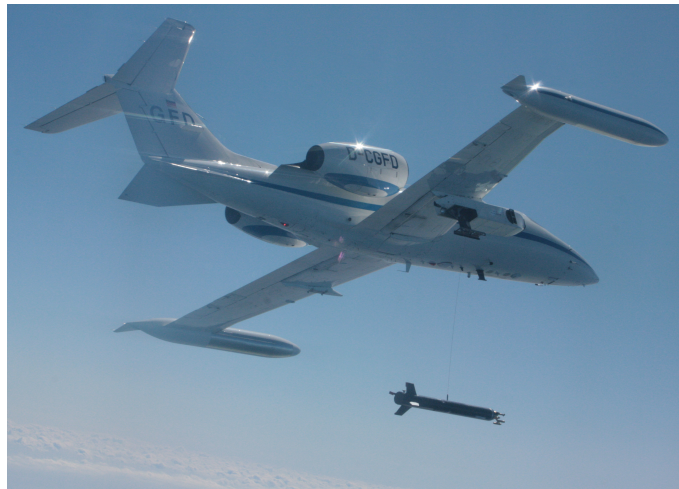
Abbildung 3.1: Learjet 35A (D-CGFD) der Gesellschaft für Flugzieldarstellung (GFD) mit dem sog. AIRcraft TOWed Sensor Shuttle (AIRTOSS). Foto: Marcus Klingebiel/ Universität Mainz.
