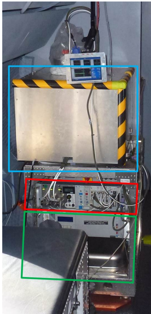
Abbildung 2.17: Das TRIHOP-Rack in HALO während TACTS / ESMVal 2012. Blau: Optik des TRISTAR-Instruments. Rot: Elektronik des TRISTAR-Instruments. Grün: HyPHoP-Instrument.
