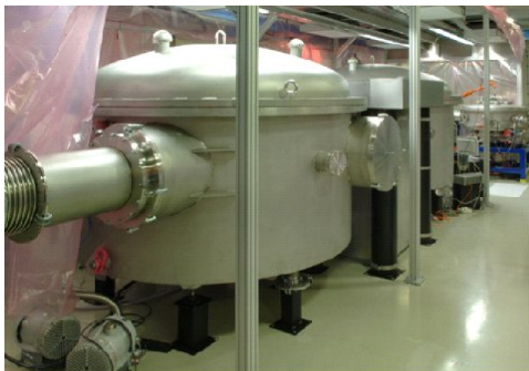
(B) Foto des PW-Kompressors. Im Vordergrund: Die das zweite Gitter beinhalten Vakuummkammer.
