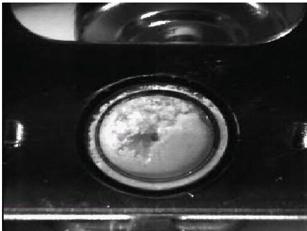
Bild 100: 100 ms Anwendung mit flüssigem Treibgas
