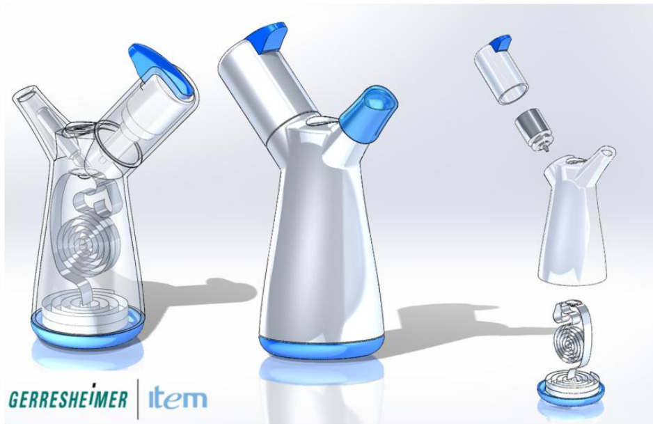
Bild 125 Entwurf 1 in einer nicht mehr für den Transport bestimmten Anordnung, mit besonders großem Vorrat an Doseinheiten.
