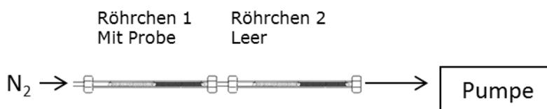
Abbildung 22: Versuchsaufbau zur Bestimmung des Durchbruchvolumens
