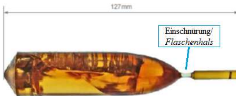
Abb. 5-31. Gezogener Flaschenhals zur Vermeidung von Zweitkörnern im Bereich der Durchmesserzunahme an einem Yb:CALGO-Kristall. Muscheliger Bruch ist vorhanden.
