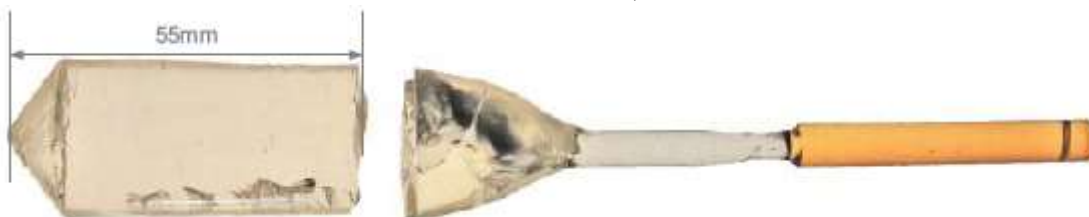
Abb. A 1-11. 2 Mol-% Yb:CaGdAlO 4 CI0038. 178 g. Stöchiometrie: 7. Neuansatz. Größtenteils rissfreier und farbloser Kristall mit geringerer Dotierung als 9,5 % Yb.
