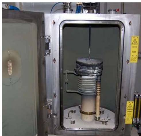
Abb. 4-14. Blick in den Innenraum der Züchtungsanlage mit Spule, Isolationsaufbau und Ziehstange.
