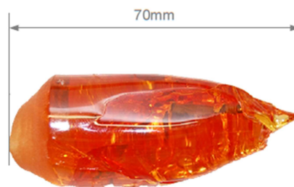
Abb. 5-17. An Ir-Stange gezüchteter undotierter CaYAlO 4 -Kristall.
