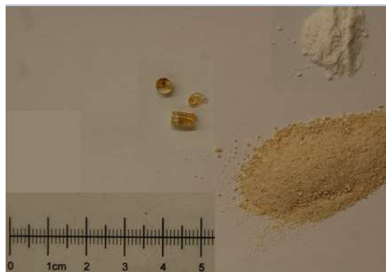
Abb. 5-26. Gesintertes \text{CaGdAlO}_4 -Pulver (undotiert) nach Zusammensetzung 1. in Tab. 5-2 (unten rechts). 9,5 Mol-% Yb:CALGO nach 7. in Tab. 5-2 (oben rechts). Links: Yb:CALGO aus optischem Zonenschmelzen.
