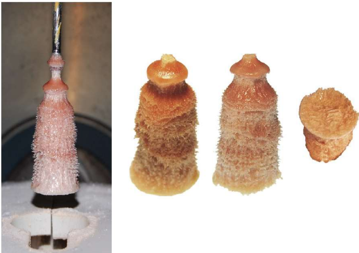
Abb. 5-24. Kristallzüchtung aus einer Schmelze der Zusammensetzung \text{CaLuAlO}_4 . Gewicht der angewachsenen Materialprobe: 115 g. Vor dem Ausbau (links), Aufnahme von beiden Seiten und der Wachstumsfront (rechts).
