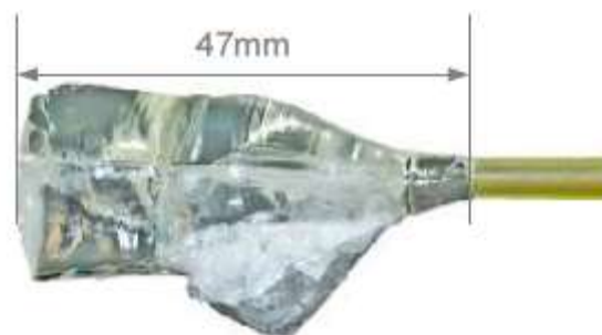
Abb. A 1-3. 9,5 Mol-% Yb:CaGdAlO 4 Y77. 152 g. Stöchiometrie: 7. Zweiter farbloser Kristall, direkter Nachfolger von Y72 aus der selben Schmelze. Stark zerrissen und parasitäre Kornbildung.
