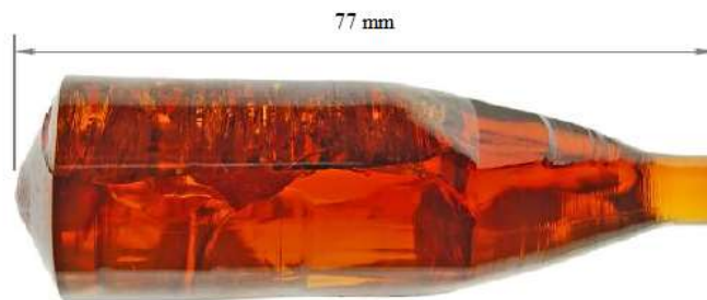
Abb. A 1-1. 2 Mol-% Yb:CaGdAlO 4 Z91. 150 g. Stöchiometrie: 1. Qualität, die zu Beginn der Arbeit Standard war (tieforange Farbe, Risse, Zweitkörner).
