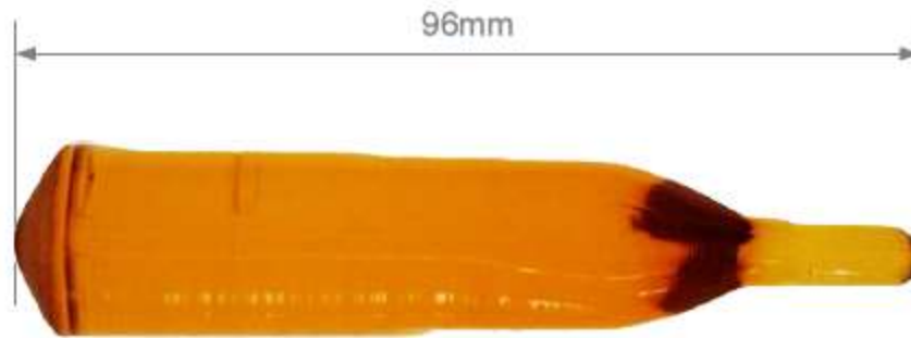
Abb. 5-18. Undotierter \text{CaYAIO}_4 -Kristall, Impfkristallorientierung \sim 22^\circ zur a-Achse.
