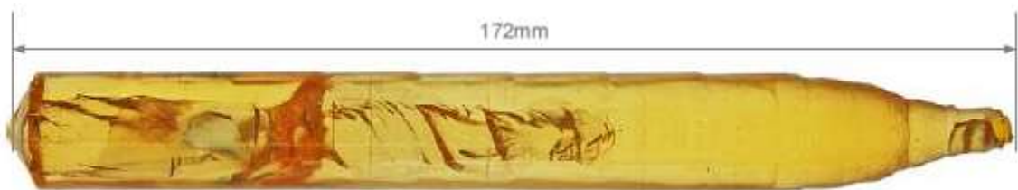
Abb. A 1-5. 5 Mol-% Yb:CaGdAlO 4 Z35. 283 g. Stöchiometrie: 5. Hellgelber Kristall mit zahlreichen Rissen. Direkter Nachfolger von Z29 aus der selben Schmelze.
