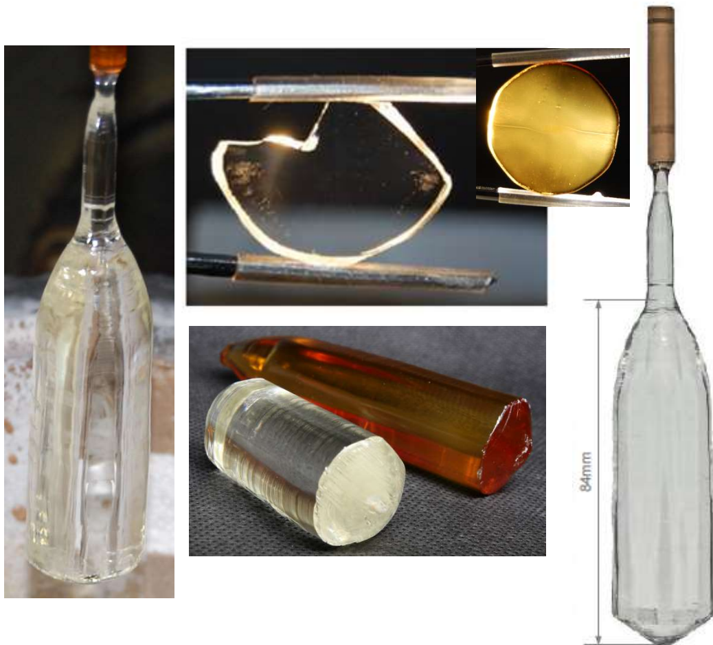
Abb. 5-16. Farblose Yb:CALGO-Kristalle aus der Schmelzzusammensetzung \text{Yb}_{1,065x} \cdot \text{Ca}_{(0,945-0,5x)-0,99} \text{Gd}_{1,065 \cdot (1-0,5x)} \text{AlO}_{(2 \cdot (0,945-0,5x)-0,99 + 3 \cdot (1,065 \cdot (1+0,5x) + 1)) / 2} ( x = 0,02 ). Der Farbkontrast zwischen orangem Impfkristall und farblosem Material ist gut zu erkennen. Polierte Kristallscheibe farblos gewachsenen Materials (Mitte oben). Man beachte die wenigen großen Streuzentren im Randbereich und die klare Mitte. Zum Vergleich ist eine polierte Scheibe aus einem orangen Kristall mit 1 Mol-% SE-Überschuss in der Schmelze gezeigt: homogene, volumenfüllende Streuzentrenverteilung, das Material ist augenscheinlich kaum transparent. Vergleich von Kristallen, die mit den Schmelzstöchiometrien 3. und 7. aus Tab. 5-2 gezüchtet worden sind (Mitte unten).
