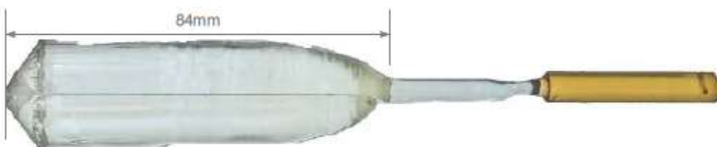
Abb. A 1-12. 2 Mol-% Yb:CaGdAlO 4 CI0039. 218 g. Stöchiometrie: 7. Neuansatz. Erster vollkommen rissfreier und farbloser Kristall mit 2 % Yb (vgl. Abb. 5-16).
