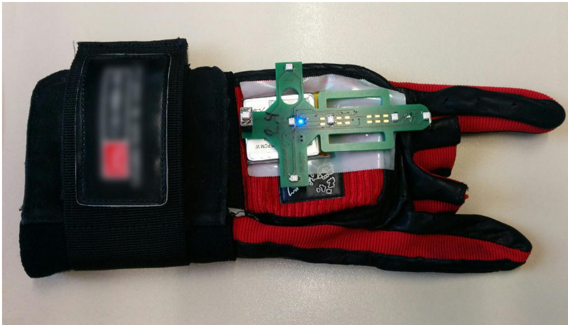
Abbildung 1.5: JGU_Numbers: [oben] Messaufbau mit IR-Kamera und IR-LED-Marker, [unten] Detailansicht: Handschuh mit IR-LED-Marker
