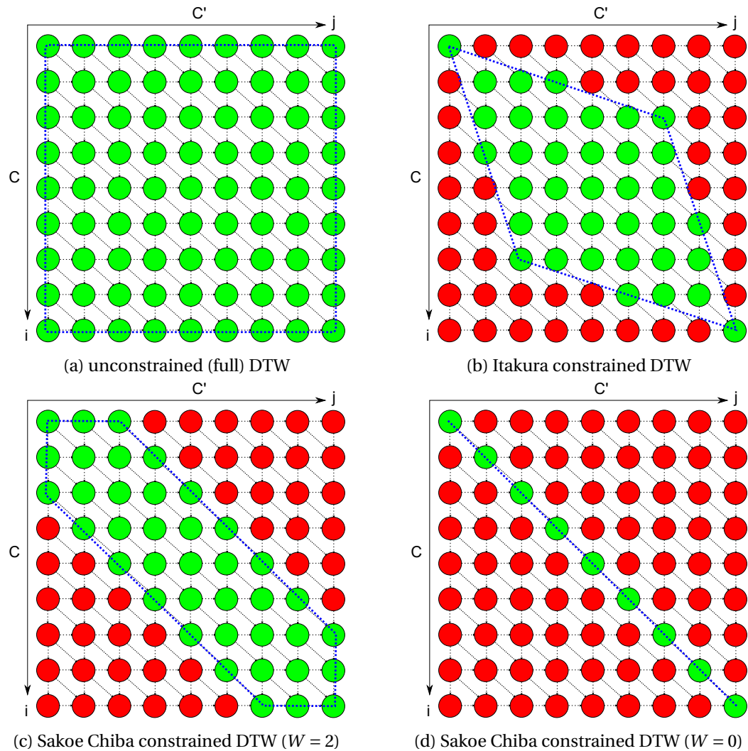
Abbildung 2.14: Darstellung der Penalty-Matrix als gerichteter Graph. Die grün dargestellten Knoten können auf den möglichen Pfaden erreicht werden. Die roten Knoten sind aufgrund der Randbedingungen nicht erreichbar. (a): Bei unconstrained DTW wird die komplette Penalty-Matrix relaxiert und jeder Knoten kann durch den Warping-Pfad erreicht werden. Bei den constrained Varianten – (b): Itakura-Parallelogramm, (c), (d): Sakoe-Chiba-Band – können durch die Randbedingungen nicht alle Knoten erreicht werden. (d): Für W = 0 kann der Warping-Pfad nur entlang der Haupt-Diagonalen verlaufen. In diesem Fall entartet DTW zum Lockstep-Abstandsmaß.
