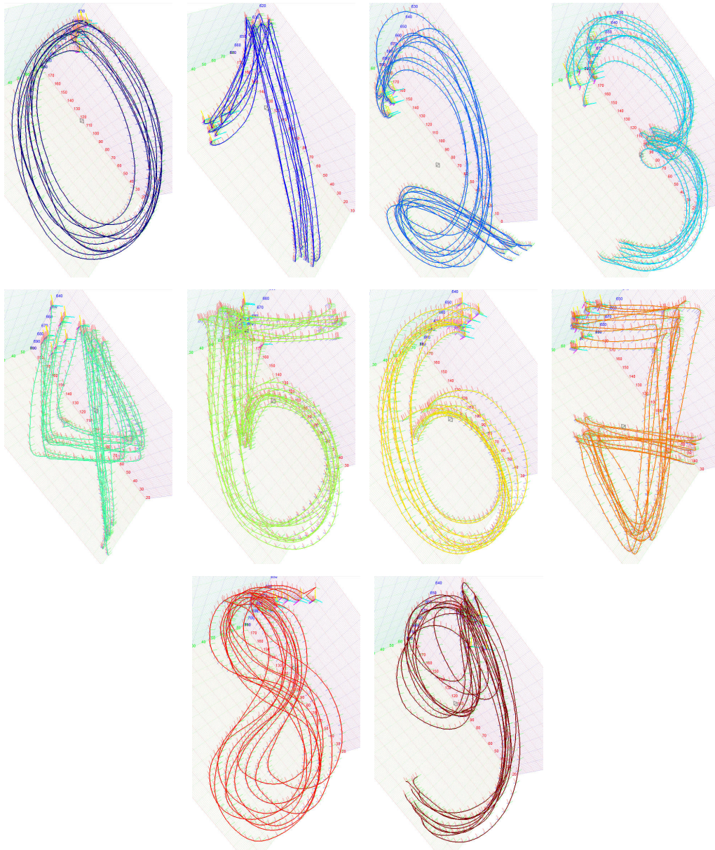
Abbildung 1.6: JGU_Numbers: Beispiele für die aufgenommenen Zeitreihen der Ziffern von '0' bis '9'. In jedem Bild sind exemplarisch 10 Instanzen der entsprechenden Ziffer als 3D-Kurve Dargestellt. Die kleinen Koordinatenkreuze repräsentieren die Orientierung des Markers zu jedem Zeitpunkt. (Weitere Informationen zur verwendeten 3D-Darstellung der 6DoF-Posen finden sich im nächsten Kapitel.)
