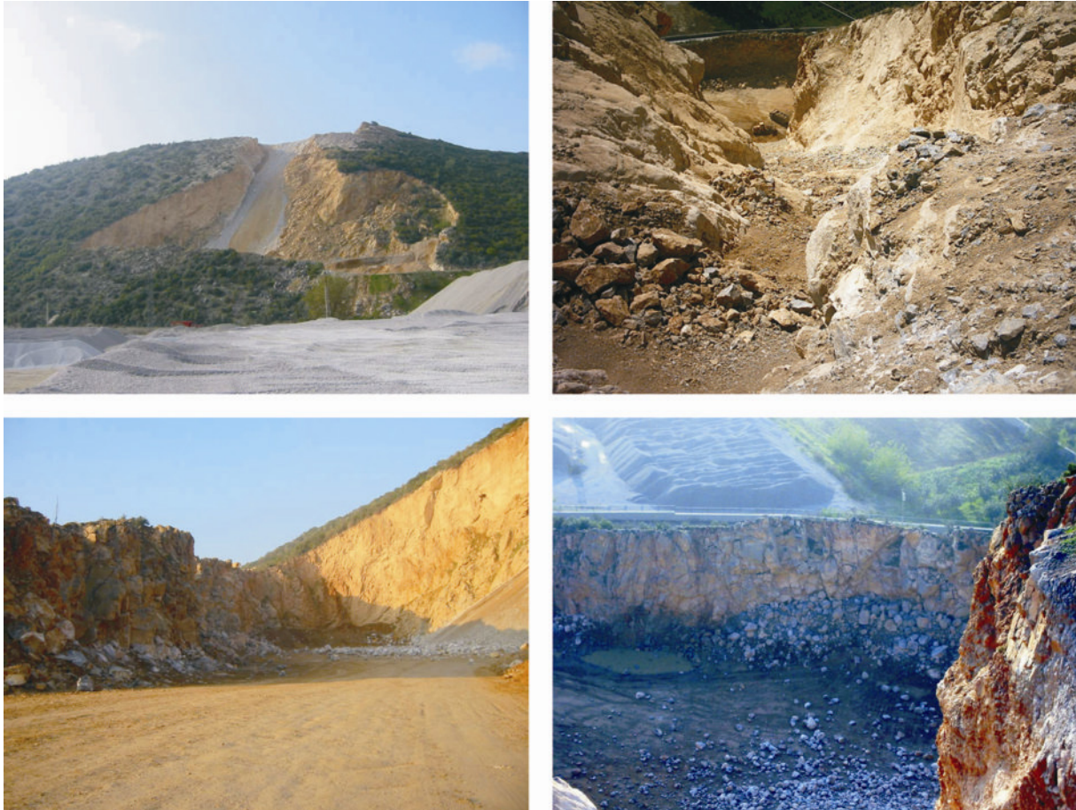
Bild 8.4: Oben: Sturzzinne im Steinbruch Bursa; unten: Prallwand (Quelle: GUDRUN GEIBLINGER, A-Linz, ANIT İNŞAAT, TR-Gürsu, AYŞE NEUMANN, D-Lennenstadt)
