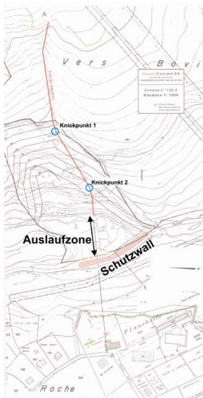
Abbildung 8.6: Verlauf der Sturzrinne mit Knickpunkten und Schutzwall aus dem Unfallbericht (HOLCIM (SCHWEIZ) AG, 1999, Anlage 139-2)
