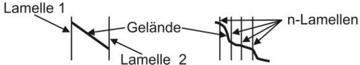
Abbildung 7.11: Bahneinteilung in Bereiche gleicher Eigenschaften durch Lamellen getrennt (Quelle: Autor)
