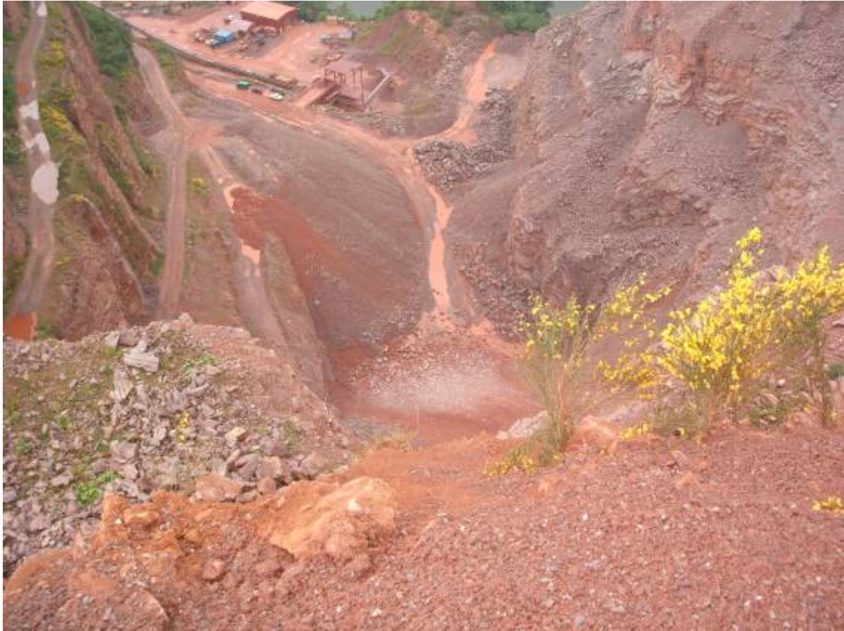
Bild 8.8: Blick in den Abbaubereich nach SW auf die Förderbezugsebene, im Vordergrund der Haufwerkskegel, links oberhalb Vorsiebmaterial, darüber Kippstelle Vorbrecher (Quelle: Autor)
