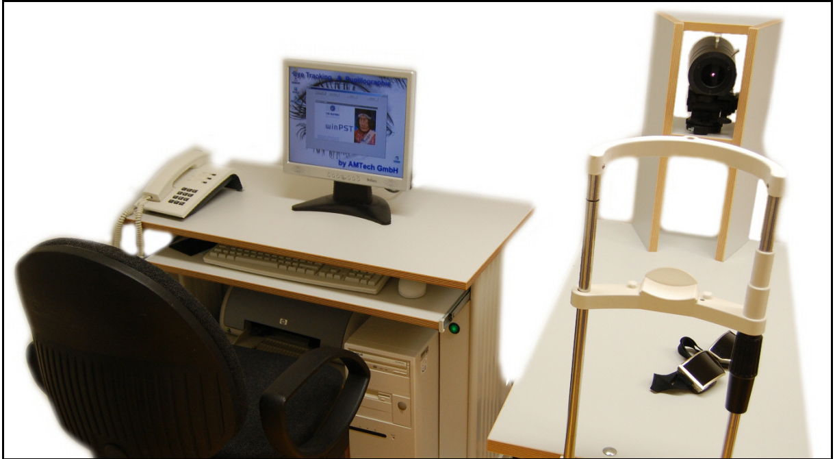
Abbildung 4.1: Aufbau des PST im Messraum für Pupillographie in der Neurologischen Klinik des Westpfalz-Klinikums Kaiserslautern
