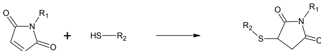
Abb. 41 Reaktionsschema für die Reaktion eines Thiols mit einem Maleimid
