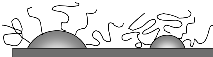
Abbildung 46: Eine stärkere Krümmung der Kugeloberfläche hat eine geringere sterische Hinderung der angekoppelten Ketten zur Folge.
