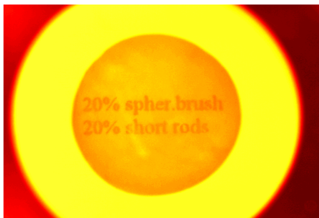
Abbildung 95: Eine Mischung aus 20Gew.% haarigen Kugeln ( M_w = 5000 \text{ g/mol} ) und 20Gew.% kurzen, haarigen Zylindern in einer Polystyrolmatrix ( M_w = 5000 \text{ g/mol} ) ergibt noch einen klaren Film.
