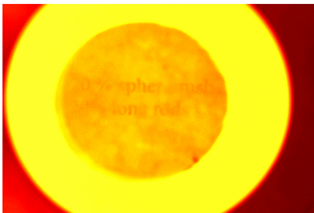
Abbildung 98: Eine Mischung aus 20Gew.% haarigen Kugeln ( M_w = 5000 \text{ g/mol} ) und 20Gew.% haarigen, langen PS-PMMA-Polymakromonomeren in einer Polystyrolmatrix ( M_w = 5000 \text{ g/mol} ) ergibt einen sehr trüben Film, durch den die Beschriftung unter dem Film nur noch schemenhaft zu erkennen ist.
