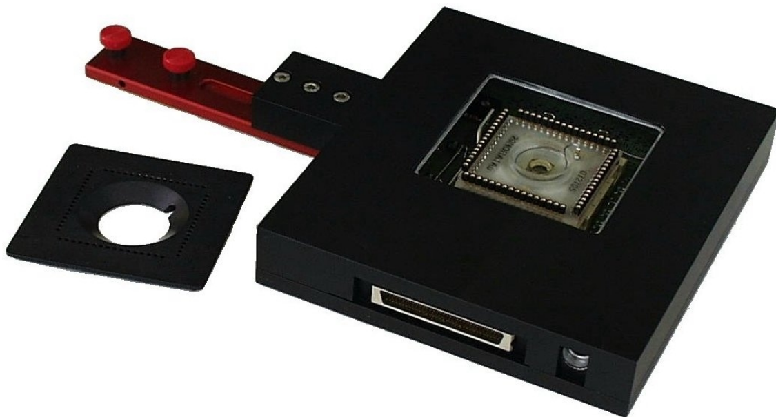
Bild 4.4: EGE Vorverstärker mit eingesetztem EGE Array und Ag/AgCl Badelektrode, sowie die zwei Abdeckungen, [Krause, 2000 a].
