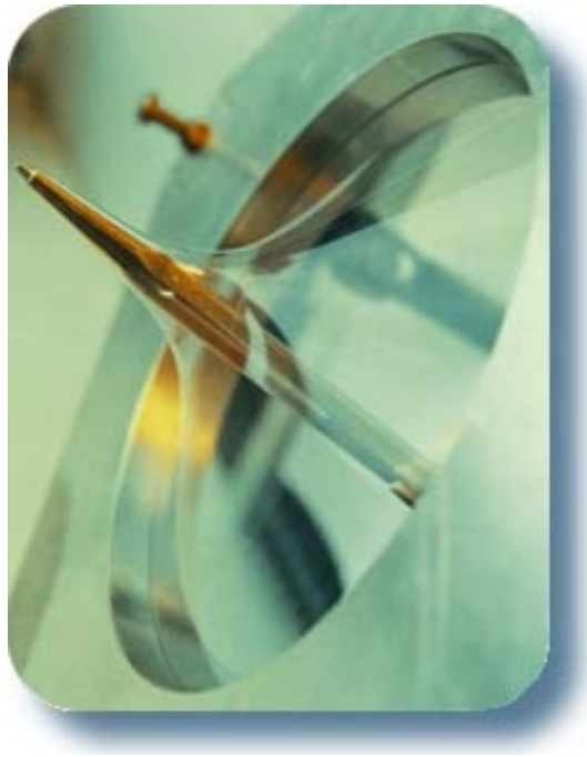
Abbildung 2: Bild einer Polyethylenfolie (Luflexen®, Elenac GmbH, LLDPE aus einem Metallocenkatalysierten Verfahren) im „Kugelschreibertest“
