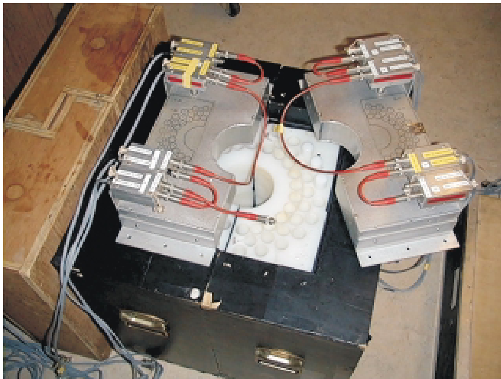
Abbildung 3.14: Photo des Neutronenzählers im zerlegten Zustand. Man erkennt so besser die Vorverstärker, die Hochspannungsversorgung und die Einschübe für die 52 Zählrohre.
