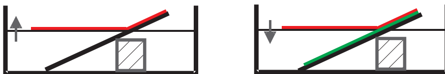
Abbildung 5.4: Schematische Darstellung des Float-Prozesses. Links: Ablösen des Deckfilms (dunkelgrau) vom Substrat (schwarz) mit steigendem Wasserspiegel (Pfeil nach oben). Rechts: Auflegen des Deckfilms auf den neuen Unterfilm (hellgrau) bei sinkendem Wasserspiegel (Pfeil nach unten).
