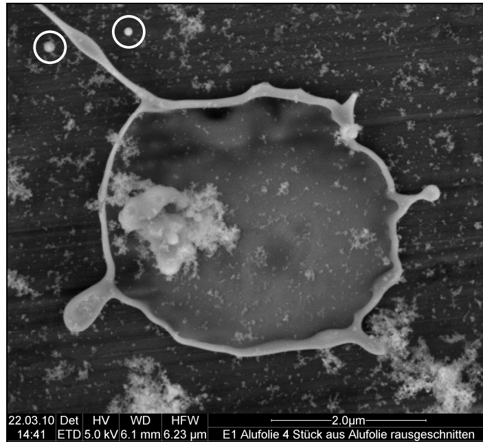
Abbildung 58 Aufgeplatzte Schmelzperle auf der Aluminiumfolie der Sprengung E
