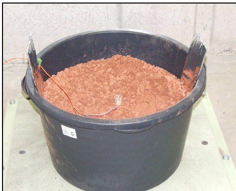
Abbildung 7 Sprengaufbau der Sprengung L (Tonmatrix)
