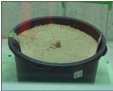
Abbildung 8 Sprengaufbau der Sprengung M (Sandmatrix)
