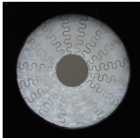
Abbildung 3.38: Fotografie der LCE-Iris mit integriertem Heizdraht.
