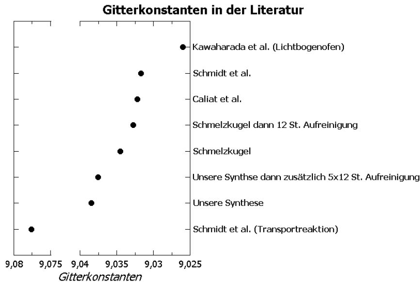
Abbildung 2.2.1: Gitterkonstanten von auf unterschiedliche Weise hergestelltem \text{CoSb}_3 . Aus Pulverdaten und aus der Literatur [55,96,98,99] (Tabelle 7.1 in EI)
