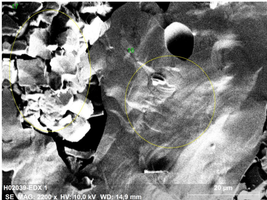
Abbildung 7.3.6: Eine der SEM-Aufnahmen eines der Bruchstücke des nominellen Ba_{0,35}CoSb_3 -Presslings. Die gelben Kreise zeigen die Bereiche, die mit EDX untersucht wurden. (Abbildungen 7.3.7 und 7.3.8)
