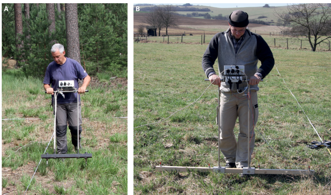
Abbildung 2-2: Elektrische Widerstandskartierung im Gelände. Fotos: P. BRENGEL.
