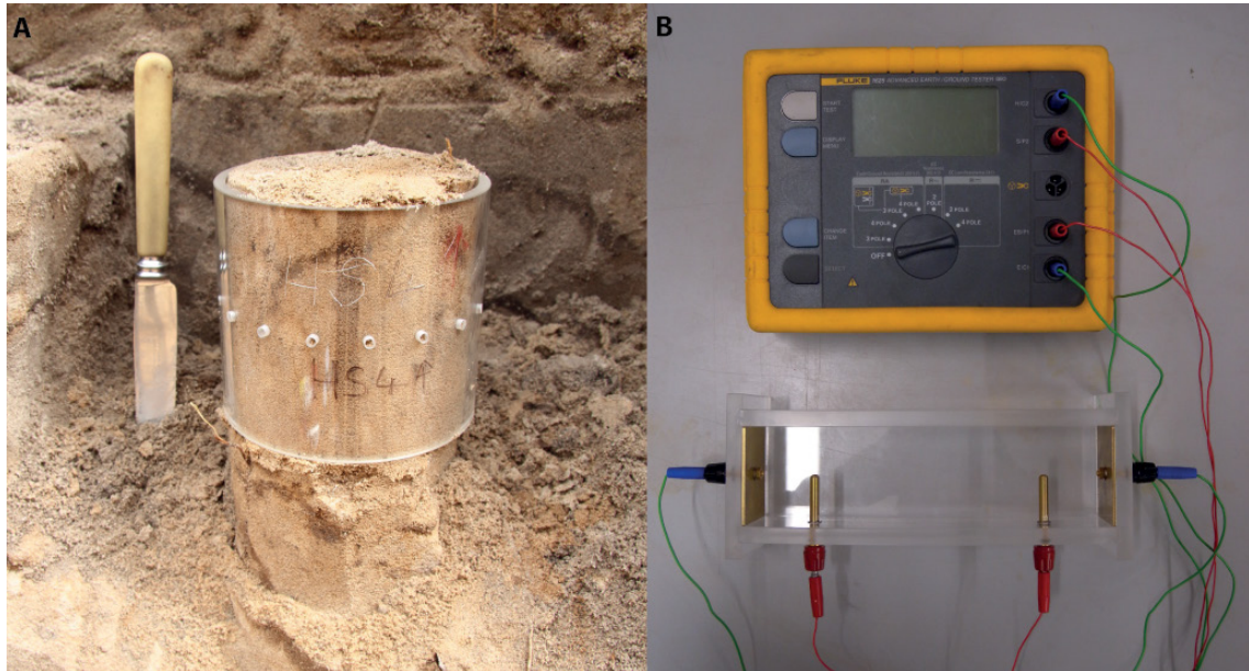
Abbildung 4-4: Entnahme von ungestörten Bodenproben mit einem Messzylinder und Aufbau einer Messbox mit Spannungsmessgerät. Fotos: P. BRENGEL.
