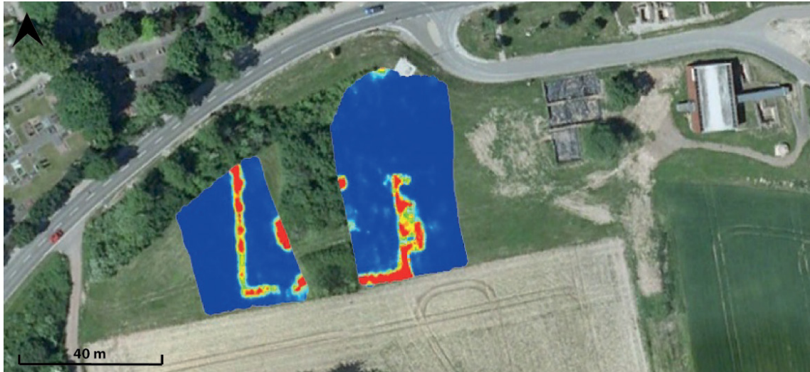
Abbildung 5-22: Ergebnisse der Prospektion mit dem Bodenradar (600 MHz-Antenne). Timeslice für die Tiefe von 30-40 cm unter der Bodenoberfläche. Luftbild: Google Earth.
