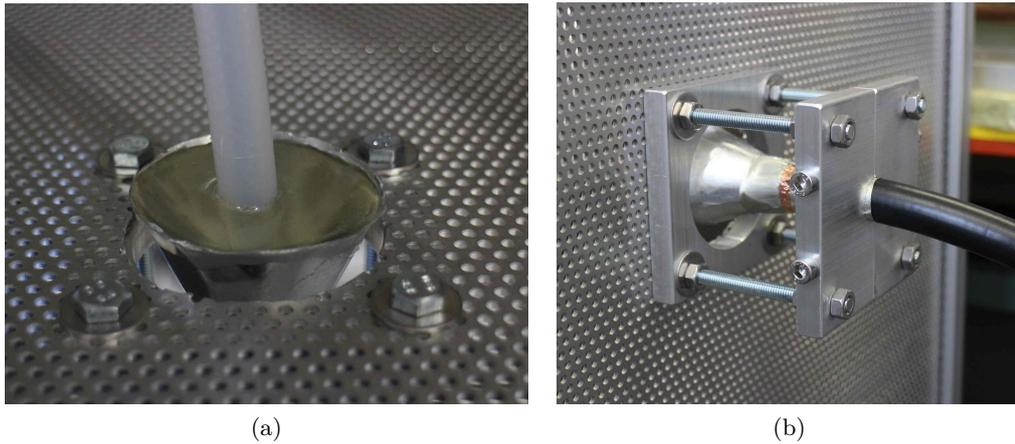
Abbildung 6.3.: Geometrische Feldsteuerung und mechanischer Anschluss der Kabelenden an einem Schirmkäfing.
