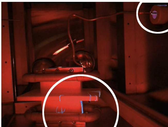
Abbildung 6.9.: Überlagerte Bilder von neun Überschlägen am Elektrodenhalter bei einer positiven Hochspannung von 90 kV.
