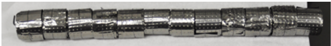
Abbildung 5.2.: Aufgerollte Titanfolien als Targetmaterial
