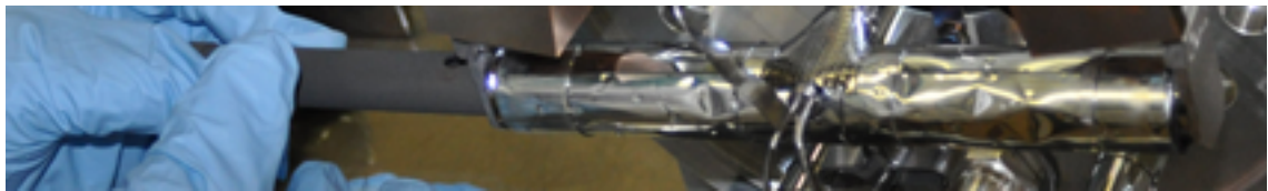
Abbildung 5.6.: Massiver Urancarbidstab als Targetmaterial.
