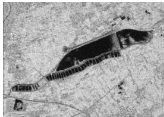
ERS-2-Aufnahme vom 06.04.1996 Windgeschwindigkeit: 1,1 m/s Windrichtung: 26° (NE) Mittlerer Rückstreuquerschnitt: -18,9 dB
