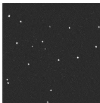
Abb. 2.6.3.1: NC-AFM Abbildung von \text{G}_2\text{-Td(-COOH)}_{16} -Aggregaten, die mittels Schleuderbeschichtung einer 3,2 \cdot 10^{-8} \text{ M} Tetrahydrofuran Lösung auf Glimmer aufgetragen wurden. Die Höhe zwischen den hellen und den dunklen Stellen entspricht 11,5 nm.
