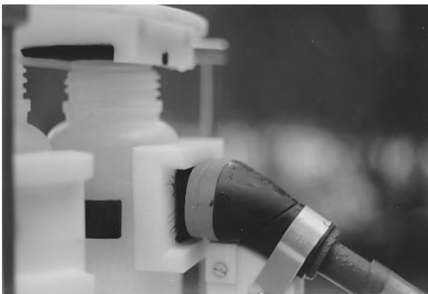
Abb.16: Saugstutzen mit Borstenrand am Auffangbehälter; links oben schwarze Schaumstofflage zur Abdichtung zwischen Fangbehälter und des zur Lampe führenden Schlauches
