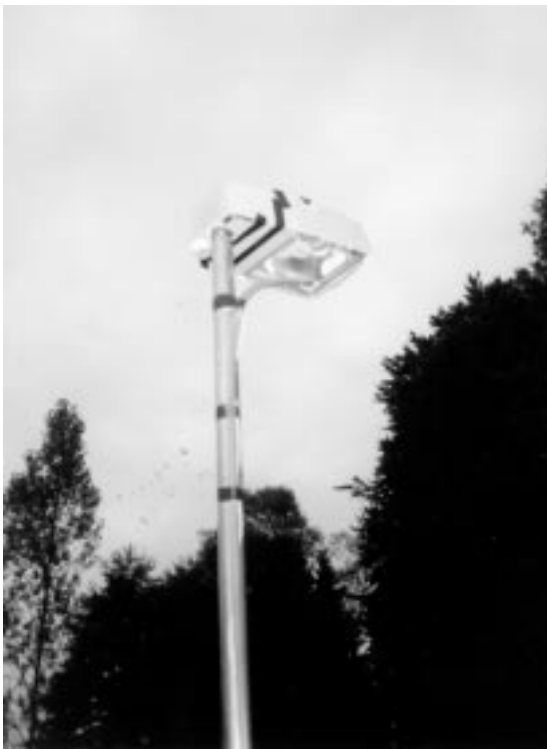
Abb.25: Abwechselnder Lichtfang von HQL und SON mit einer Kastenleuchte; der Schlauch zum Absaugen der Insekten ist in der Mitte der Kunststoffabdeckung der Leuchte befestigt
