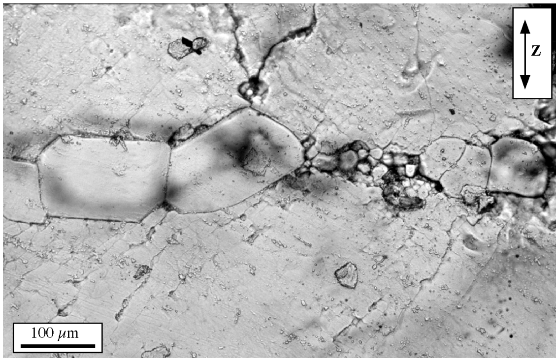
Abbildung 3.22: Dünnschliff-Photo einer bei Raumtemperatur, 5 MPa Manteldruck, 10^6 s^{-1} Verformungsrate und bis zu 21% Verformung deformierten NaClO_3 -Probe (ZDS02; Korngröße 1-2 mm). Die wachsenden Fragmenten können relativ sehr groß werden und verhindern somit die weitere Bewegung der Scherzone.
