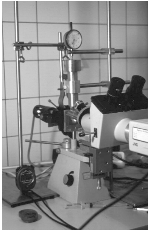
Abbildung 5.1: Deformationsgefäß mit Horizontalmikroskop
