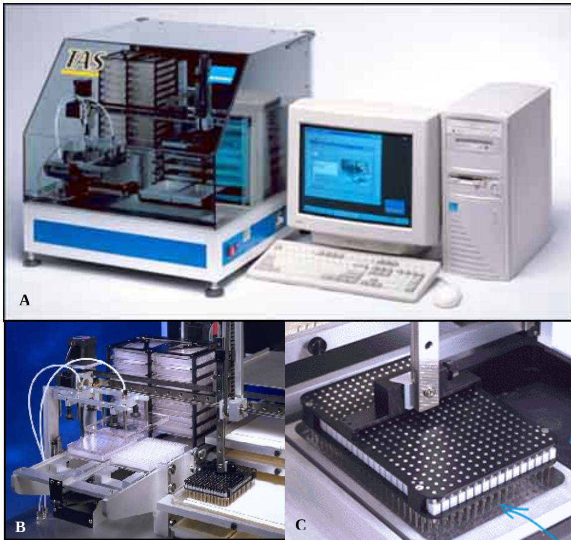
Abb.2.1: A) Roboter "Biogridder" mit Steuerungseinheit der Firma BioRobotics, Cambridge UK für die Herstellung von DNA-Arrays. B) Nadelkopf überträgt 384 Proben parallel auf einen festen Träger. C) Druckkopf des Roboters mit 384 Nadeln für den Proben transfer.
