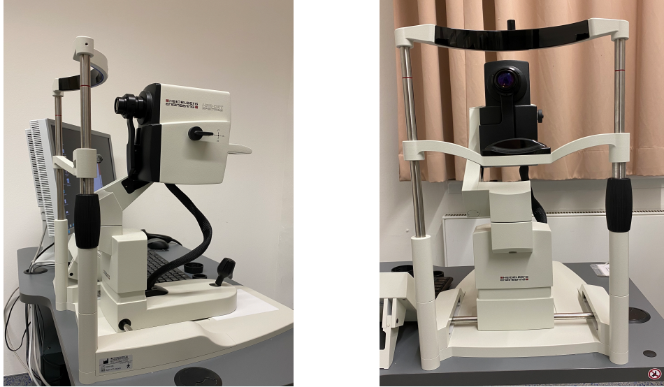
Abbildung 9 Aufbau der Spektral-Domänen optischen Kohärenztomographie im Untersuchungsraum Dargestellt ist der Aufbau der Spektral-Domänen optischen Kohärenztomographie (SD-OCT), die für die Erhebung der Daten an der Universitätsmedizin der Johannes Gutenberg-Universität Mainz verwendet wurde. Das linke Bild zeigt die Ansicht von der Seite. Das rechte Bild zeigt die Ansicht aus der Sicht der Teilnehmenden.
