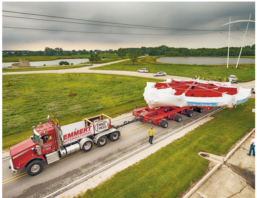
Abb. 1 Ankunft der supraleitenden Spulen des Magneten, der das Herz des Myonenspeicherrings bildet, auf dem Gelände des Fermi National Accelerator Laboratory (Foto: R. Hahn, Fermilab).
