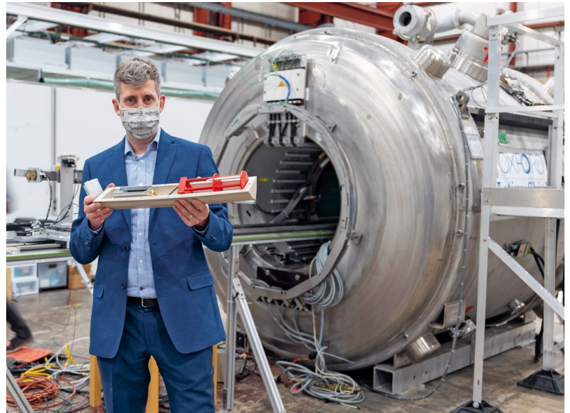
Abb. 4 Peter Winter mit einer Testversion der beweglichen Feldkamera vor dem Teststandmagneten am Argonne National Laboratory (Foto: Argonne Nat. Lab.).
