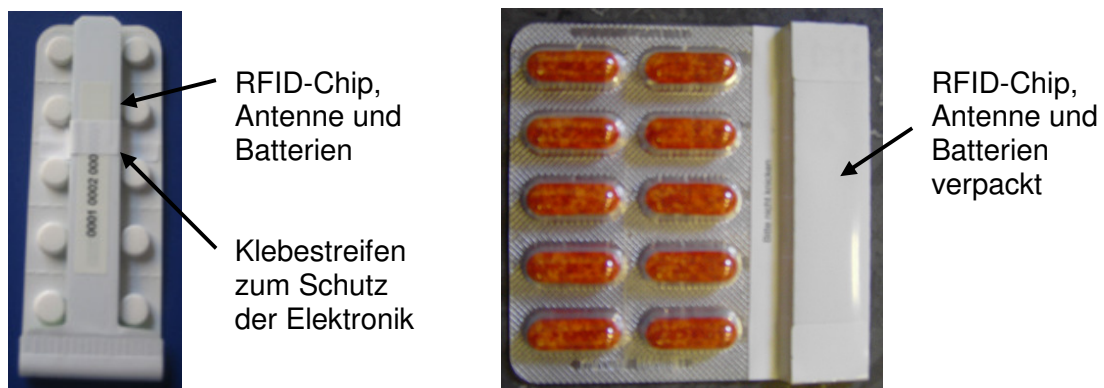
Abbildung 5.5-1 Phenprogamma®-OtCM-Blister mit offener Blistertechnik und isolierendem Klebestreifen (links); Rekawan®-OtCM-Blister mit isolierter Blistertechnik (rechts)
