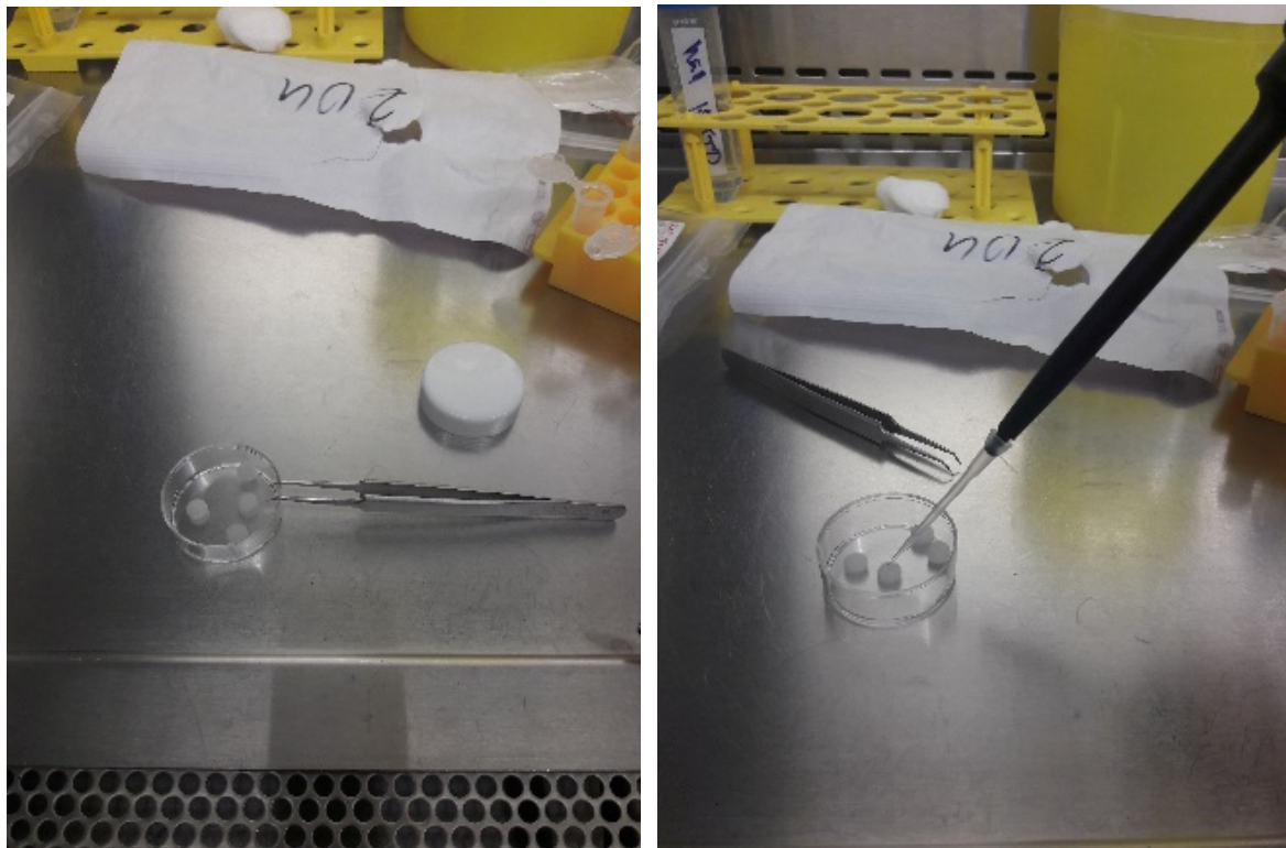
Abbildung 12: Arbeiten an der Sterilbank, Vorbereitung der Kollagenscaffolds in der Petrischale (links), Pipettieren der Untersuchungssubstanz auf Schwämmchen (rechts)
